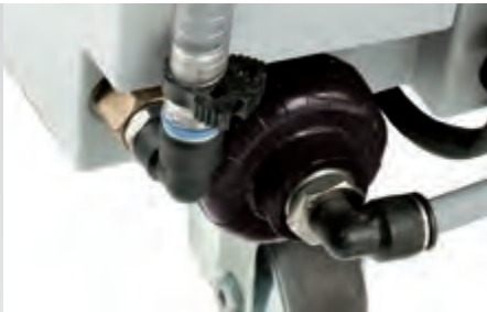
Grosser, integrierter Schmutzfilter schützt vor Verstopfungen des Zufuhrsystems.
