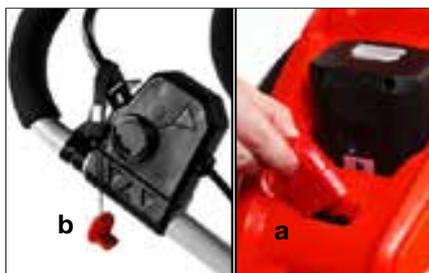
Les **clés de sécurité** présentes dans le logement de la batterie (Fig. a) et sur le guidon (Fig. b) assurent votre tranquillité même en présence d'enfants. Elles permettent en effet d'éviter que la tondeuse ne redémarre toute seule.
