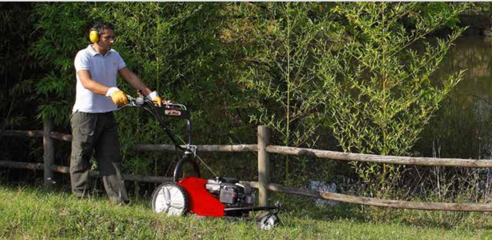
Terrains en pente, hautes herbes et jachères sont les défis pour lesquels ces machines ont été construites. Les grandes roues au profil spécial passent partout. La largeur de travail élevée et une traction efficace permettent de tondre de grande surfaces en un temps record. Le réglage de la hauteur de coupe est centralisé et se règle par un levier fixé sur le guidon.
